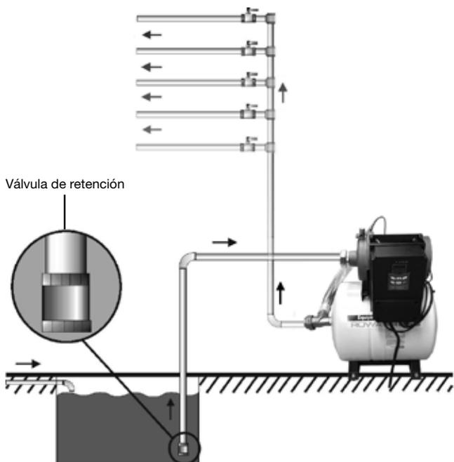
**A.2)** La tubería de alimentación del presurizador proveniente del tanque elevado o cisterna deberá poseer un diámetro igual o mayor a 1 1/2" (una pulgada y media) nominal.
